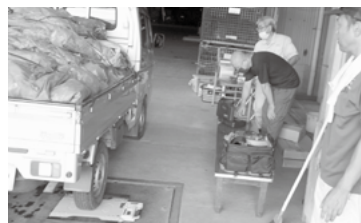
▲トラックスケールにて重量を計測
